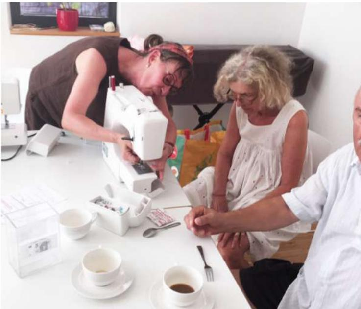
Manchmal sind's Winzigkeiten. So wie bei dieser Nähmaschine. Eine fast unsichtbare Krümmung der Nadel hat unserem Gast die Freude am Nähen ziemlich verdorben. Umso einfacher war die Problemlösung: eine neue Nadel eingesetzt und schon ertönte ein freudiges Rattern der Maschine.
